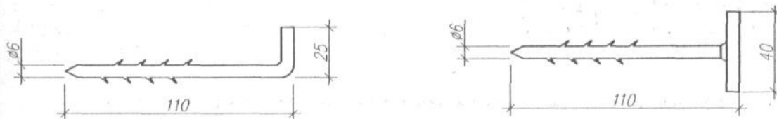
Рис. 3.2. Штыри для крепления плит
