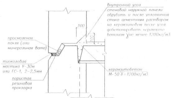
Рис. 1.12. Герметизация и утепление горизонтальных стыков (Серия 502)
