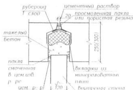
Рис. 1.1. Устранение протечек через стыки панелей наружных стен (Серия 1-464А)
